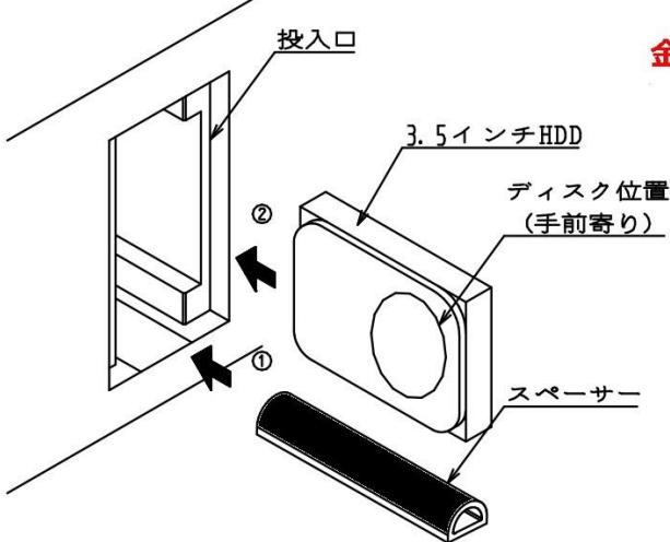
金属カバーを左面、内部プラッターを手前側にして挿入
